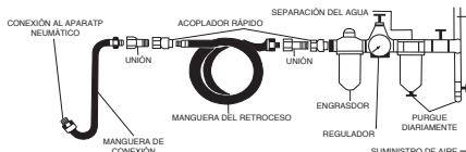
Esta herramienta debe conectarse a un suministro de aire limpio y seco, con un engrasador y un separador de agua en línea.
