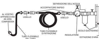
Aria sporca e umida corrode rapidamente le parti interne di lavoro della macchina e ne riducono la durata di lavoro in modo significativo. Acqua si raccoglie nel serbatoio del compressore e provoca corrosione grave. Il serbatoio deve essere svuotato ogni giorno per evitare che l'acqua si accumula nell'aria di alimentazione
