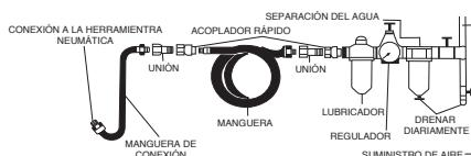
**Nota:** Este filtro regulador y lubricador no es compatible para usar en tareas de pintura (pistola para pintar, etc.), a no ser que vacíe y retire completamente el aceite lubricante del filtro.
